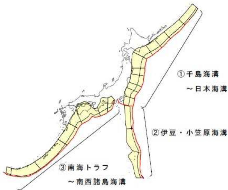
解説図1 プレート間地震に起因する津波波源の対象領域
