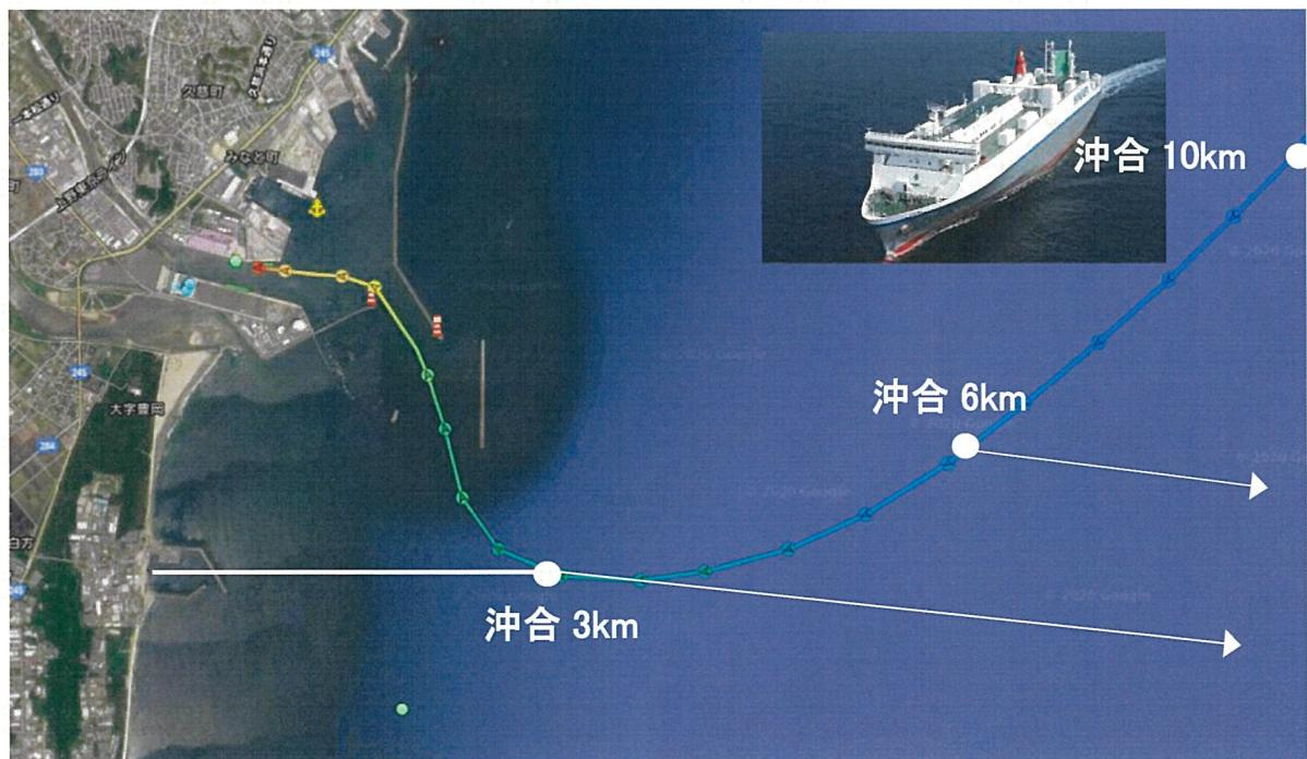
ホクレン丸が緊急避難時に仮に性能最高速度を上回る 26.0 ノット（時速 48 km、分速 800m）を出せたとして、沖合 3 km 地点を航行中に津波地震を感じて直ちに沖合に向かって最高速度で航行した場合、避難海域である沖合 17 km 地点までの距離 14 km を性能最高速度で緊急避難するときの所要時間は 17.5 分である。津波発生後 24.7 分後に沖合 19 km 地点に到達する基準津波と出会ってもなんとか津波流速を乗り越えられる避難海域に入っている。
