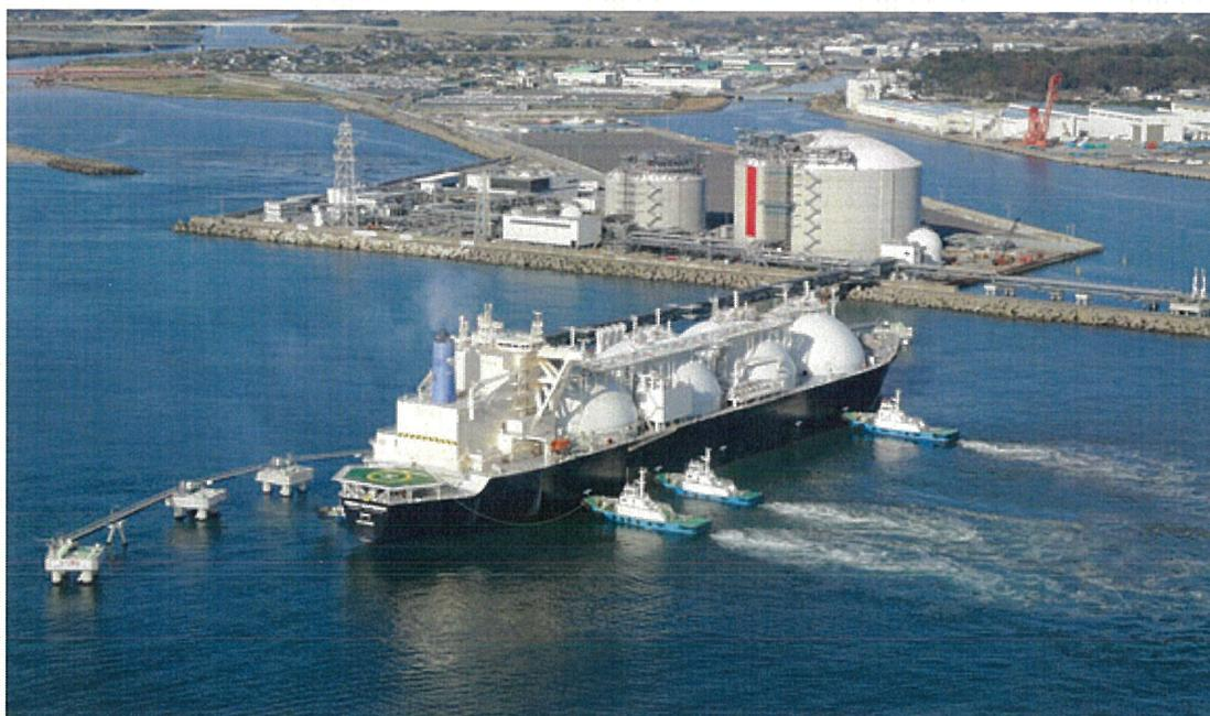
写真のように、中央航路（水深14m）に入る前にエンジンを停止してタグボートでゆっくり曳航し（重量が重いので慣性力が大きく、動き出すとそのまま動いていって栈橋に衝突してしまうため）、LNG船の外航バースに着栈して、パイプを接続する。離着栈の時だけでなく、風、波浪および不測の事態に備えて常に港湾業者によるタグボートが張り付いているとのこと。
