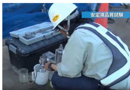
安定液の管理項目は、比重、粘性、pH。孔壁崩壊の要因のトップは、「安定液の水位が低い」こととされている。
