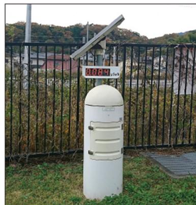
実際の測定器 (モニタリングポスト)の様子
